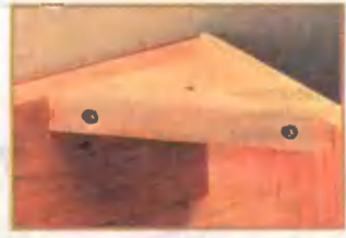
Держатель подгоняется между боковыми стенками к задней стенке.
