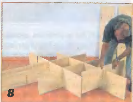
8 Сначала этажерку собирают насухо, пользуясь при этом схемой сборки.
