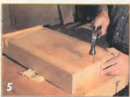
5 Чтобы в открытом положении ящика дно не выпало, оно прибивается гвоздями.
