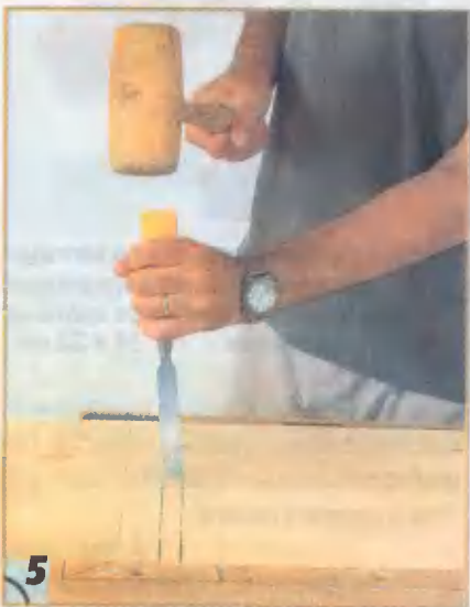
5 Сделав два пропила в заготовке, лишнюю древесину аккуратно удаляют стамеской.
